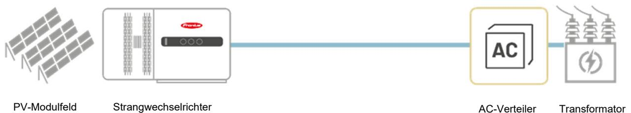
Abbildung 1: Aufbau dezentrales Systemdesign
